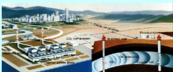
Figura 1. Captura de CO 2 para recuperación de petróleo.
